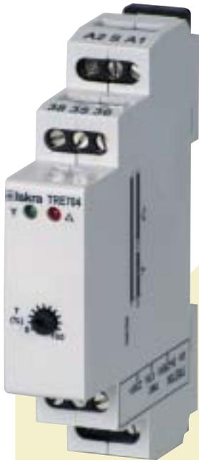
Nach dem Anlegen der Spannung ist für die Zeitdauer T1 das Relais Y eingeschaltet, es folgt die Pause mit einer Zeitdauer von T2 = 100 ms und dann schaltet das Relais  $\Delta$  andauernd ein.
