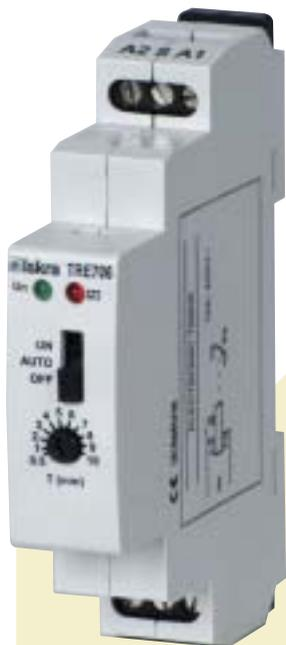
**Option B:** Das Signal S schaltet das Relais für die eingestellte Zeitdauer T ein. Wenn das Signal S länger als 6 Sekunden lange dauert, verlängert sich die eingestellte Zeitdauer t um den Faktor 8 (bei der Option B). Die Aktivierung der verlängerten Zeitdauer wird durch eine veränderte Helligkeit der roten LED angezeigt. Wenn das Signal S (ein Druck auf die Taste) erneut noch vor dem Ablauf der Zeit T erscheint, beginnt die Zeit T von Anfang an zu zählen.
