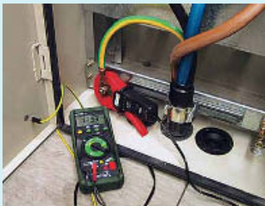
③ Messung des Ableit- oder Fehlerstromes mit einer Stromzange
