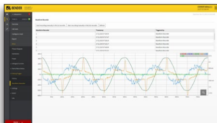
Darstellung von Gerätedaten auf der Weboberfläche (COM465IP)
