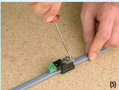
1. Anschlussdose abisolierfrei auf das asymmetrische Bus-Flachkabel aufsetzen.
